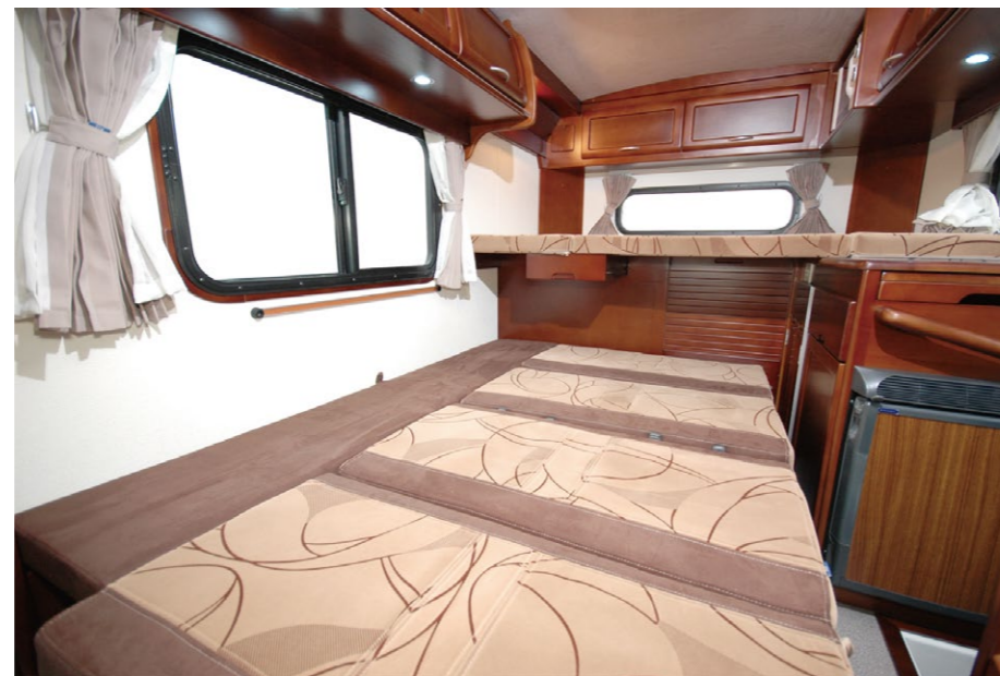
シートを展開しサブマットを入れるだけで1900×1280mmのベッド
