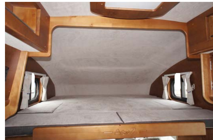
Bank bed —バンクベッド センターパネルを引出しサブマットを入れることで大型ベッドの完成 SIZE:1850×1740×750mm (H)
