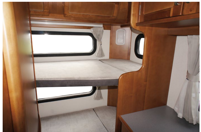
Standing bed —常設ベッド SIZE: 上段 1800×780 (640) ×740mm (H) 下段 1800×780 (640) ×630mm (H) 二段ベッド下は収納スペースで外部バゲッジドアからアクセスも可能です
