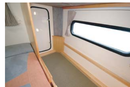
リヤベッドマットを取り外すと外部バゲッジドアからもアクセス可能な大きな収納庫
