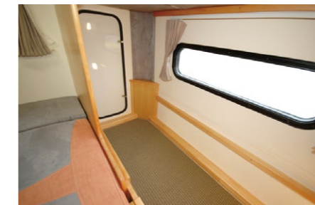
リヤベッドマットを取り外すと外部バゲッジドアからもアクセス可能な大きな収納庫
