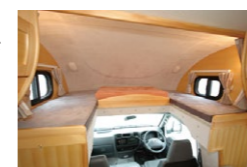
センターパネルを引き出すだけで1800x1420x650 (H) mmのベッド
