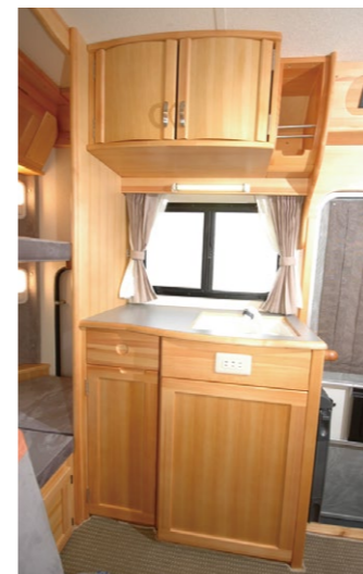
充実したキッチンには40L (12V) 冷蔵庫を標準装備。蛇口は引き出しても使えるシャワーフォーセットタイプ。引き出し収納、給排水 (各10L) タンク、AC100Vコンセントなども装備。上部収納庫にはオプションで電子レンジの装備も可能。
