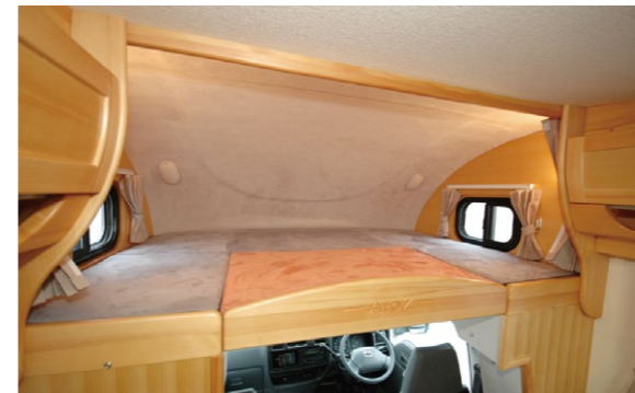
センターパネルを引き出すだけで1800x1420x650 (H) mmのベッド
