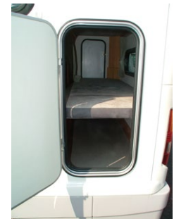
■リア常設2段ベッド 上段1840×660×700mm 下段1840×660×620mm ベッドの収納は外部バゲットドアからも出し入れできます。
