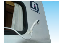
伸縮式シャワーヘッドは窓ガラスから外に出し専用フックに引っ掛けることで 外部シャワーとしても使えます。
