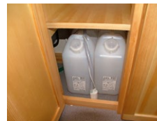
■清/排水タンクは10L タンクの出し入れは車内からと 下の写真のバゲットドア (2段ベッド下)から出来ます。
