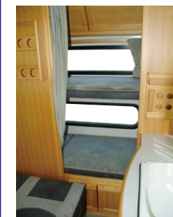
■リア常設2段ベッド 上段1840×660×700mm 下段1840×660×620mm ベッドの収納は外部バゲットドアからも出し入れできます。
