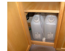
満/排水タンクは10L タンクの出し入れは車内から下の写真の パゲジドア(2段ベット下)から出来ます。
