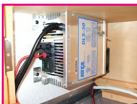
バッテリーチャージャー
