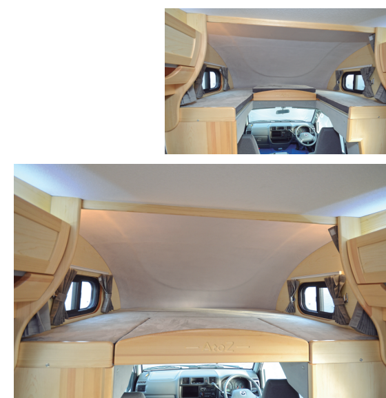
センターパネルを引き出すだけで 1800×1420×650(H)mmのバンクベッド
