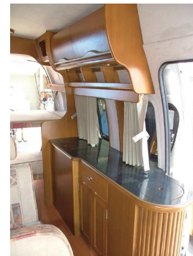
ダイネットからでも使いやすいカウンター キッチン 40L上蓋式冷蔵庫 20L 清排水タンクを標準装備
